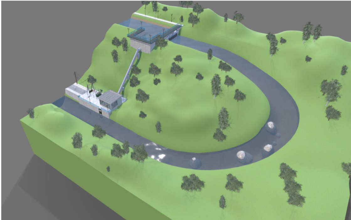
Илюстрация: принцип на работа на проточна деривационна водоелектрическа централа
