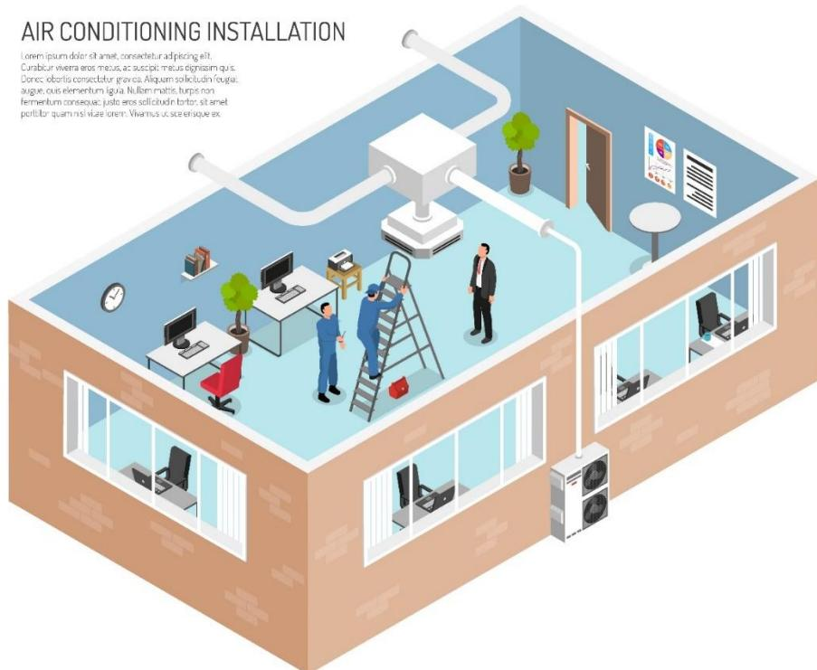
Toplota se preko topotne pumpe i posrednog medijuma (freona) dovodi do izmenjivača toplote unutar prostorija i tamo se oslobađa preko vazduha. Jedan spoljni kompresor najčešće opslužuje jednu unutrašnju jedinicu mada ima i verzija sa dve ili čak tri unutrašnje jedinice ili sa centralnim izmenjivačem toplote preko koga se vrši distribucija vazduha kroz unutrašnji sistem cevi.
